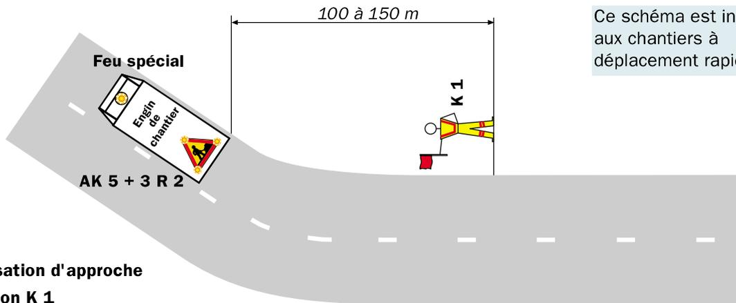
Ce schéma est inadapté aux chantiers à déplacement rapide
