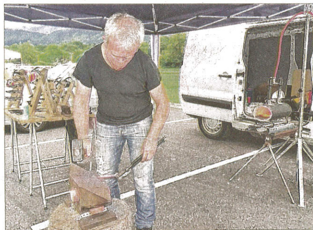
Après avoir porté au rouge l'acier dans le four, Yan Moretti le met en forme à l'aide d'un marteau et de son enclume. Photo Le DL/C.B.
